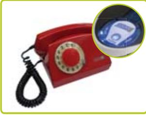
SIPcode Box sincronizado, led on-line estabilizado e power aceso, telefone no gancho e led do phone apagado.
