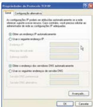
Se a opção “Obter um endereço IP automaticamente” estiver selecionada, seu(s) computador(es) trabalha(m) em DHCP (IP dinâmico).
