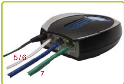
Conectando o cabo RJ11 de 12cm (5) com adaptador ou cabo RJ 11 de 1,5 m (6). O cabo verde (NÃO FORNECIDO (7) que liga o SIPcode Box ao computador ou rede, na porta LAN.
